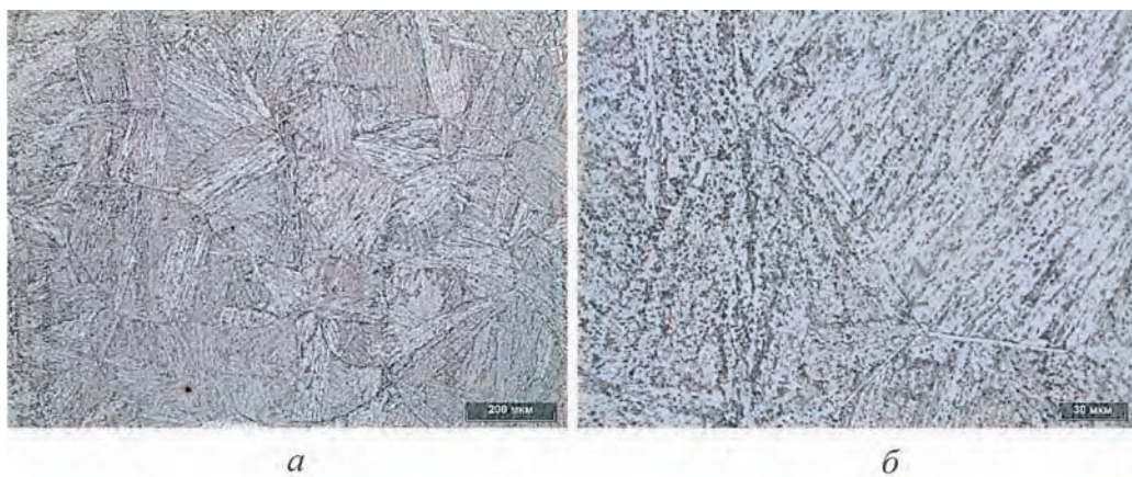
Рисунок 6.52. Микроструктура образца из стали 56NiCrMoV7 после охлаждения со скоростью 54\text{ }^{\circ}\text{C}/\text{час} до изотермической выдержки 690\text{ }^{\circ}\text{C} (30 часов) с температуры 1200\text{ }^{\circ}\text{C} , с последующим полным охлаждением: а) \times 100 ; б) \times 500
