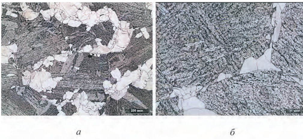
Рисунок 6.46. Микроструктура образца из стали 56NiCrMoV7 после охлаждения со скоростью 30\text{ }^{\circ}\text{C}/\text{час} до изотермической выдержки 650\text{ }^{\circ}\text{C} (30 часов) с температуры 1200\text{ }^{\circ}\text{C} , с последующим полным охлаждением: а) \times 100 ; б) \times 500
