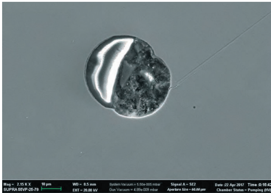
Рисунок 5.5. Включение системы \text{CaO}-\text{Al}_2\text{O}_3-\text{SiO}_2-\text{MgO} (пл. № 189476)
