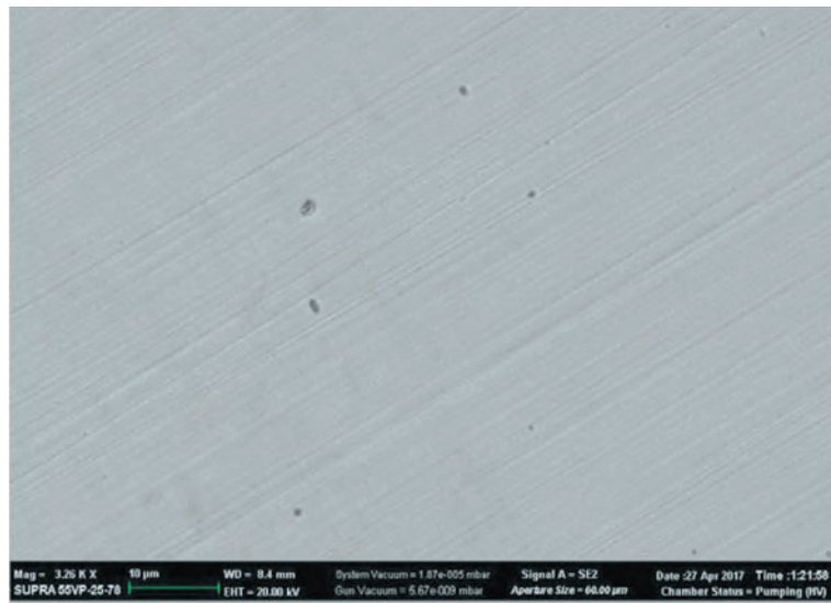
Рисунок 5.22. Соединения сульфида марганца \text{MnS} на плавке 189507
