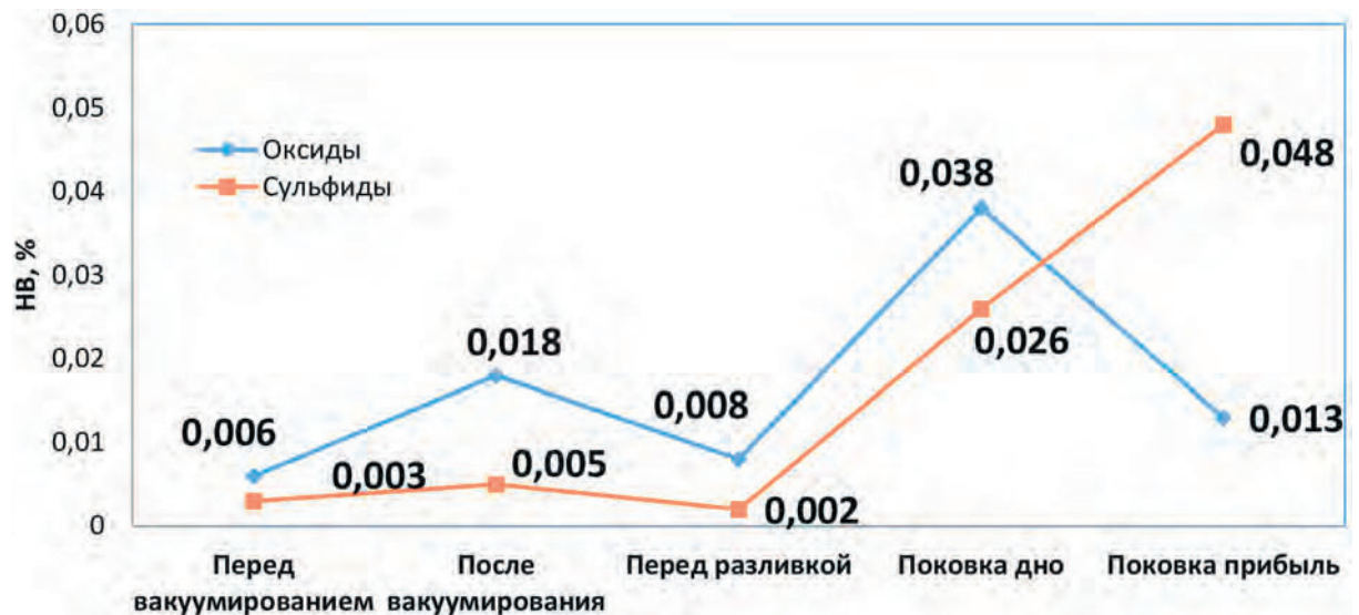
Рисунок 5.17. Загрязненность неметаллическими включениями оксидными и сульфидными на плавке 189507 по ходу технологического процесса
