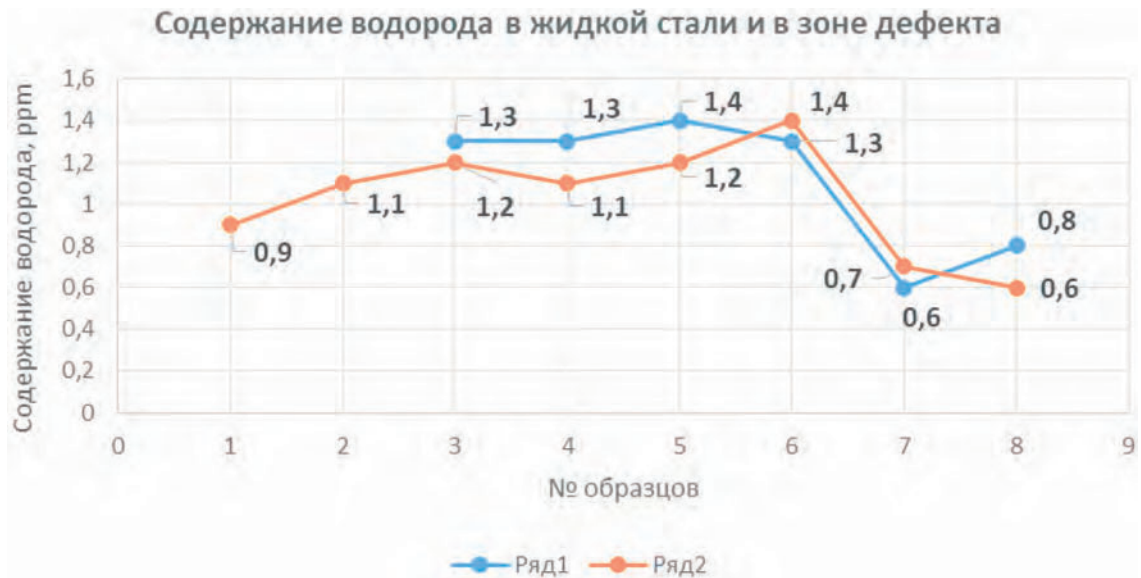
Рисунок 3.2. Содержание водорода в жидкой стали и в поковке в зоне дефекта: ряд 1 — содержание водорода в жидкой стали; ряд 2 — содержание водорода в зоне дефекта
