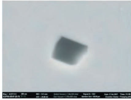
Рисунок 5.16. Остроугольные включения \text{Al}_2\text{O}_3 в образце с разливки на плавке № 102593
