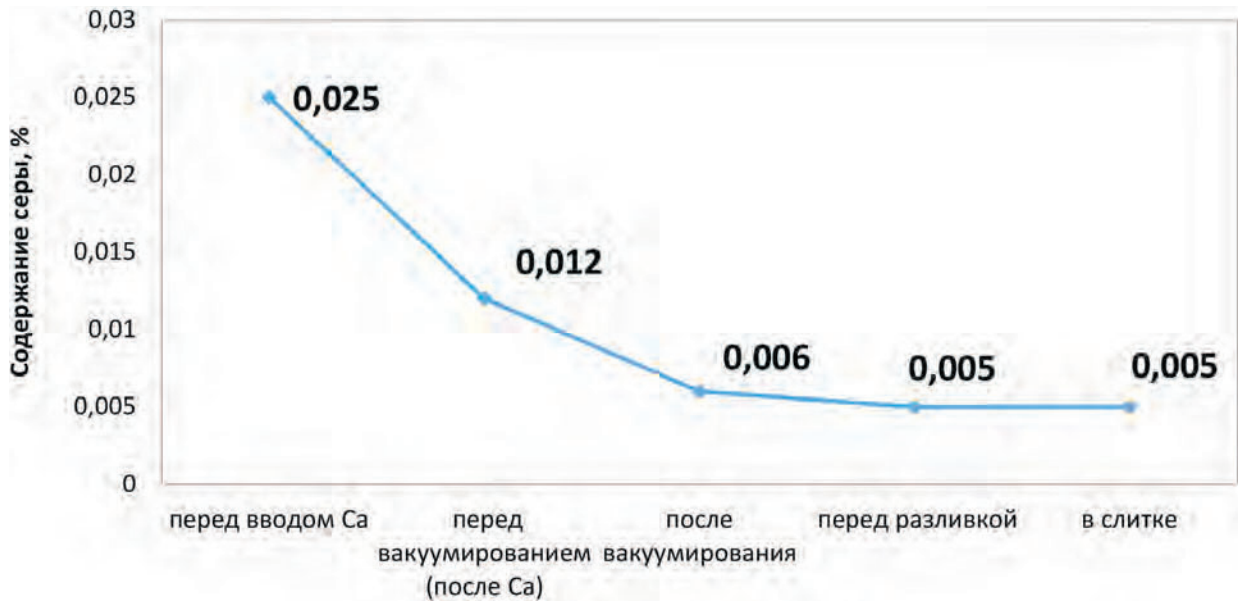
Рисунок 5.4. Изменение содержания серы по ходу технологического процесса на плавке 102593
