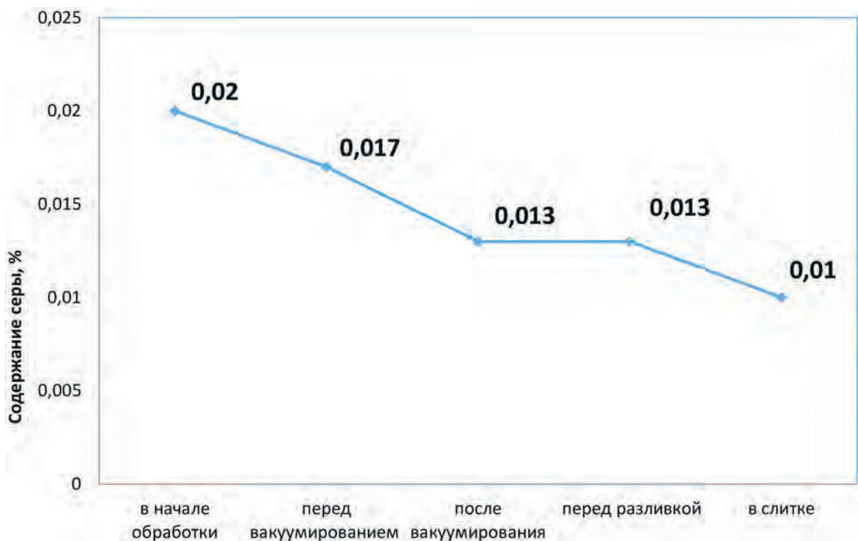
Рисунок 5.20. Изменение содержания серы по ходу технологического процесса на плавке 189507
