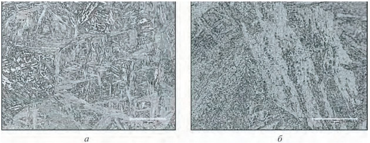
Рисунок 6.16. Микроструктура образца из стали 56NiCrMoV7 после непрерывного охлаждения со скоростью 0,05\text{ }^{\circ}\text{C}/\text{с} с 1200\text{ }^{\circ}\text{C} : а) \times 100 ; б) \times 500
