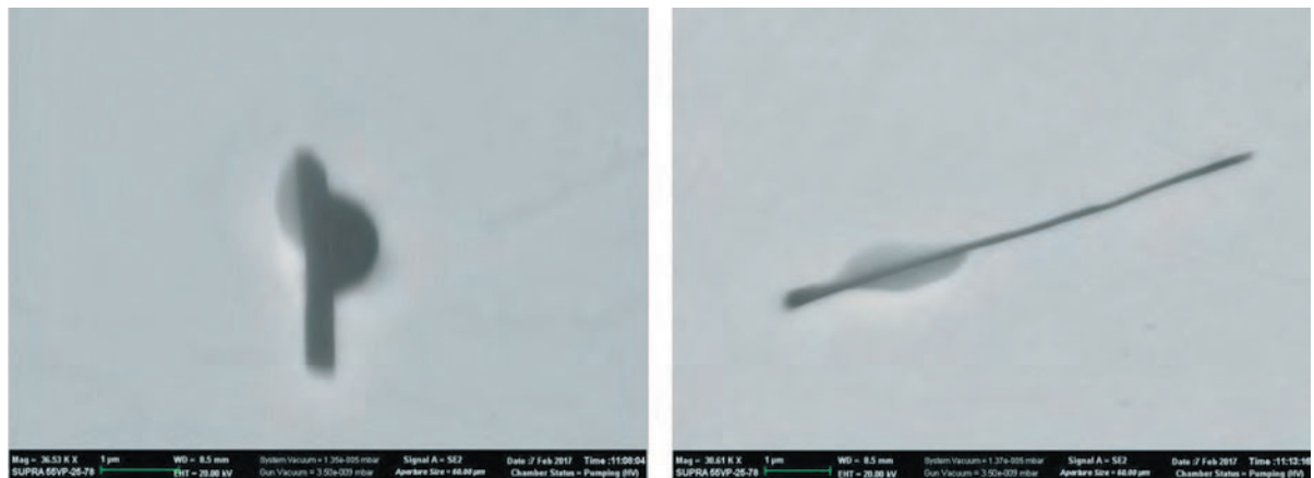
Рисунок 5.15. Оксисульфиды системы \text{Al}_2\text{O}_3\text{--MgO} + \text{MnS} в образце с разливки на плавке № 102593
